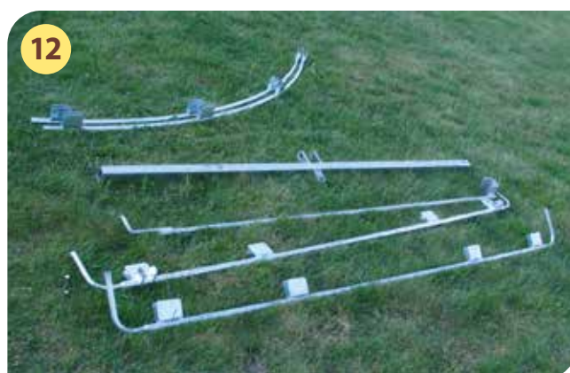
12 Dachkantenschutz und Transporthilfe für Dreipunkthanhängung.
