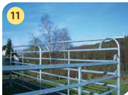
Vierkant-Verbindungsstück D auf die Seitenpanels legen und mit Befestigungswinkel L verschrauben (M8 x 70 3 ). Der Schraubenkopf muss nach außen zeigen.
