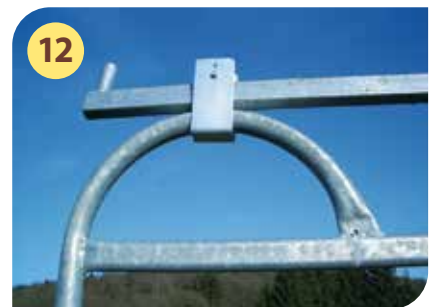
Vierkant-Verbindungsstück D auf die Seitenpanels legen und mit Befestigungswinkel L verschrauben (M8 x 70 3 ). Der Schraubenkopf muss nach außen zeigen.
